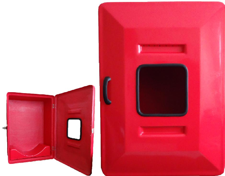
Armários para mangueiras em PRFV (Plástico Reforçado com Fibras de Vidro). Dispensam pintura, pois são pigmentados durante a fabricação com gel coat aditivado contra raios UV's.
